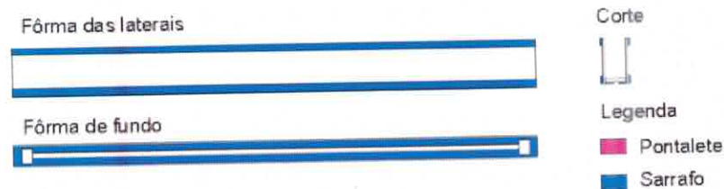
Figura 2: Fabricação de fôrma de viga interna (compensado)
